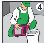
Для подготовки раствора залейте водопроводную воду комнатной температуры в чистую ёмкость из расчёта 0,24-0,28 л воды на 1 кг сухой смеси.
