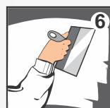
Шпатлевку БОЛАРС «Универсал» нанесите стальным шпателем на основание слоем от 1 до 10 мм. Для получения более толстого слоя допускается шпатлевание в несколько слоев. Последующий слой нанесите после полного высыхания предыдущего, предварительно прогрунтав поверхность грунтующими составами БОЛАРС.
